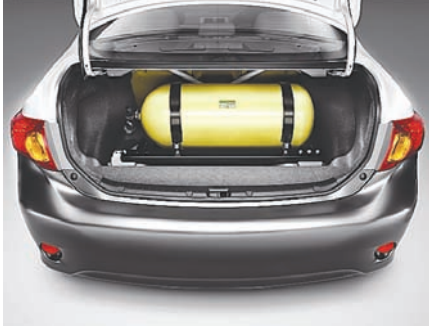
படம்-2:காரில் இருக்கும் CNG சிலிண்டர்
